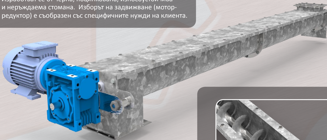
Коритообразен винтов транспортъор от поцинкована стомана
